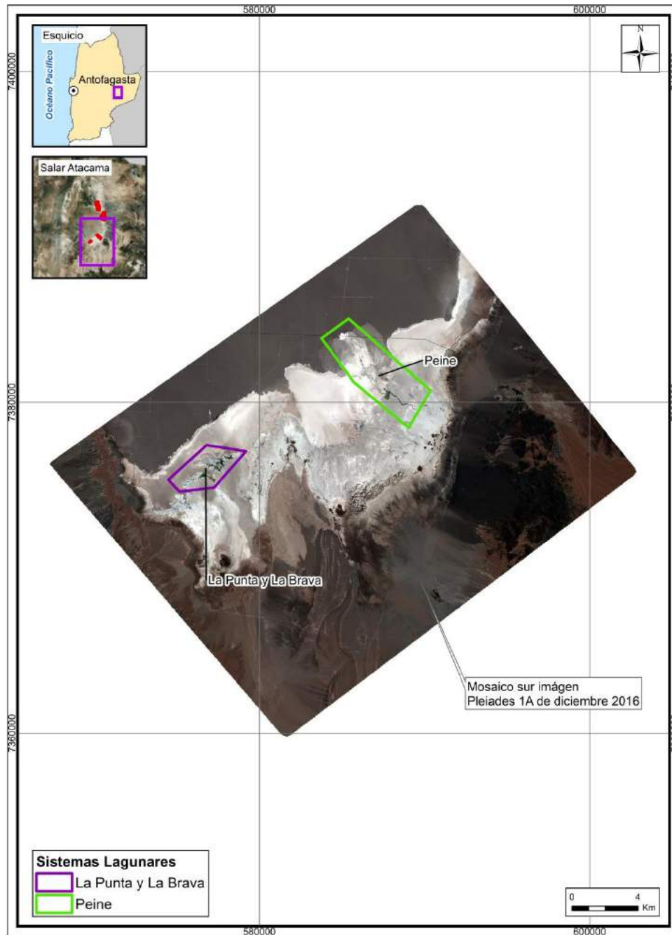
Figura N° 10-3. Esquema de mosaicos sur de imágenes de alta resolución Pleiades-1A usados para la determinación de la cobertura de cuerpos de agua en sistemas lagunares del Salar de Atacama.
