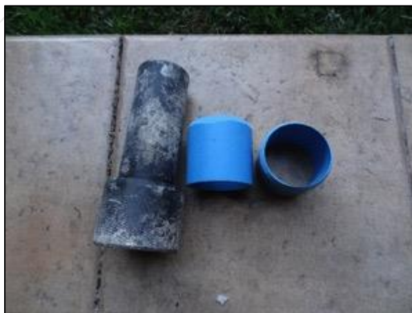
Fotografía N° 8-1. Materiales utilizados para extraer muestras de suelo para conductividad hidráulica (permeabilidad).
