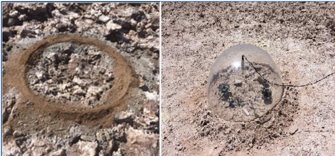
Figura 4-13 Preparación del terreno e instalación del domo
