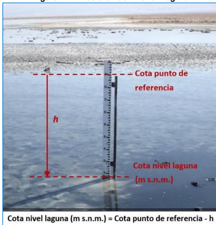
Figura 4-21 Medición de nivel en reglilla
