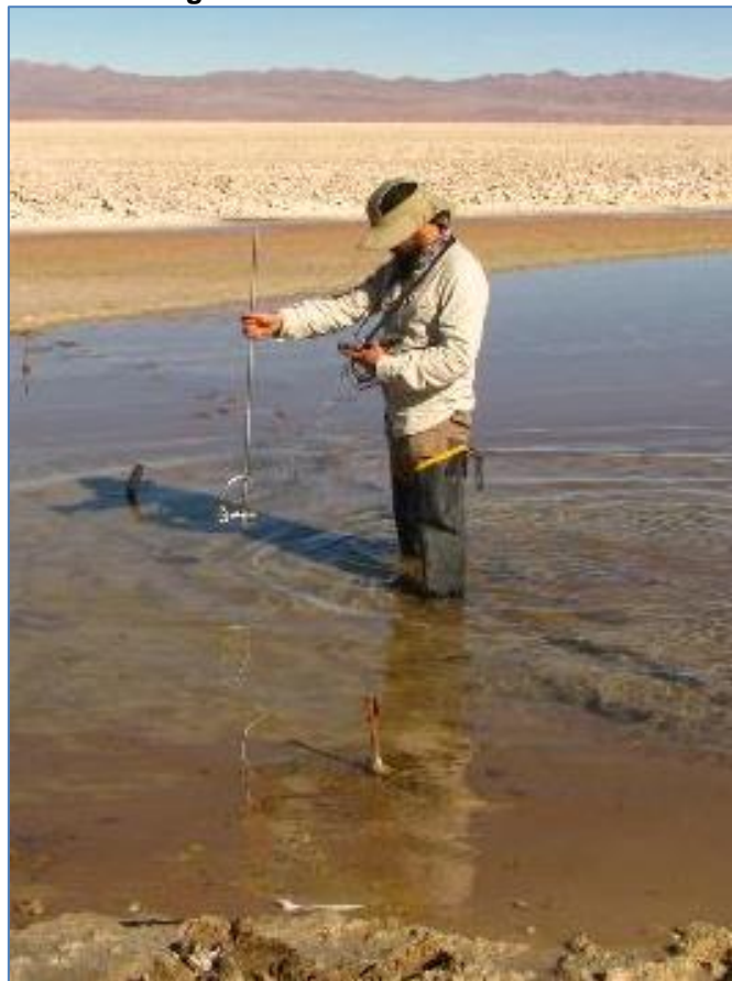
Figura 4-19 Aforo con molinete
