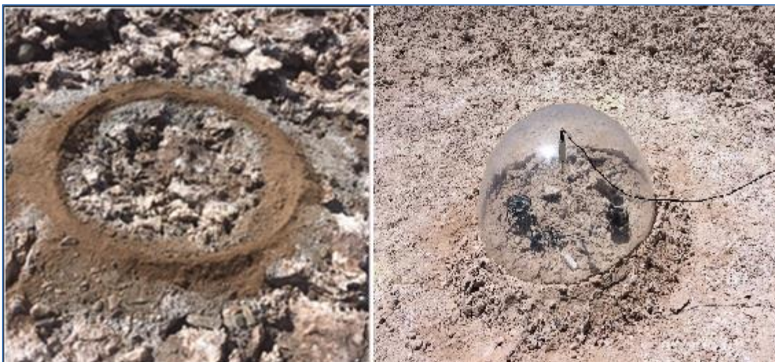
Figura 4-13 Preparación del terreno e instalación del domo
